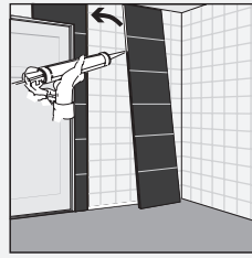
Afkitten met Fibo seal tussen profiel en panelen
